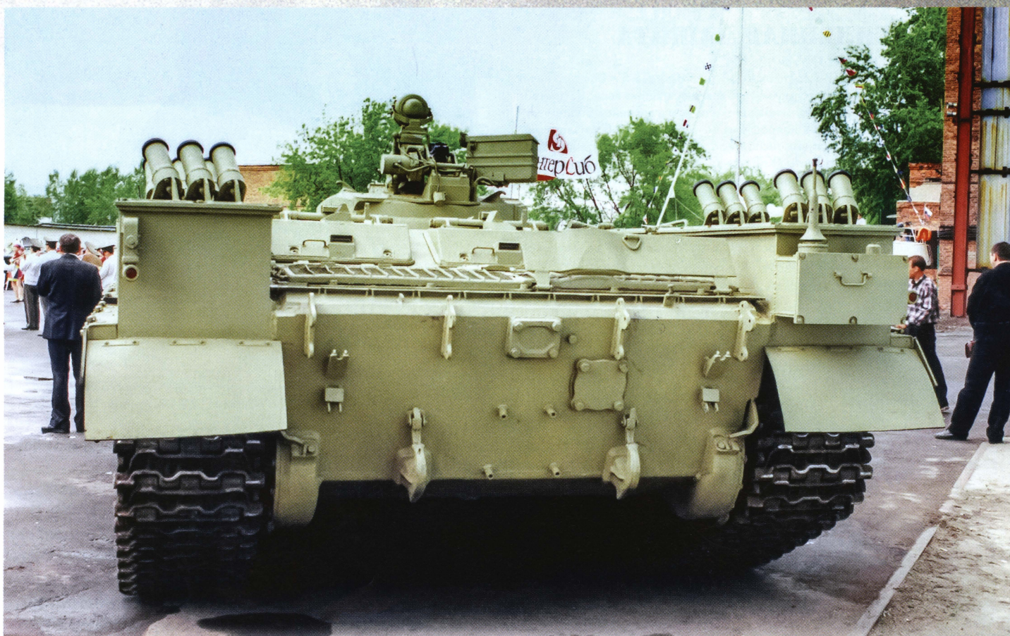
Тяжелый бронетранспортер БТР-Т, вид сзади. Справа хорошо виден антенный ввод радиостанции.
