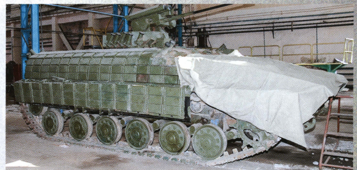
Украинская тяжелая БМП-64 на базе танка Т-64, общий вид. Машина оснащена комплексом навесной динамической защиты «Контакт-1».
