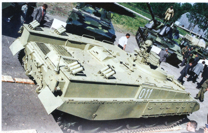
Бронетранспортер БТР-Т, вид сверху. Хорошо видна установка дымовых гранатометов «Туча».
