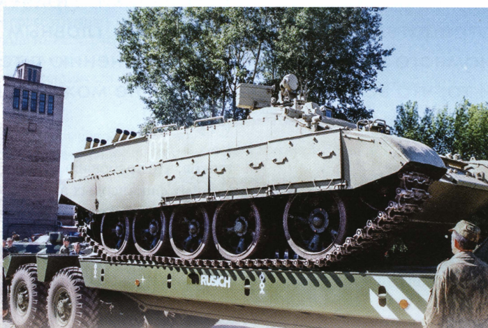
Бронетранспортер БТР-Т на трейлере перед отправкой на полигон. Хорошо видны блоки дополнительной защиты на борту машины.
