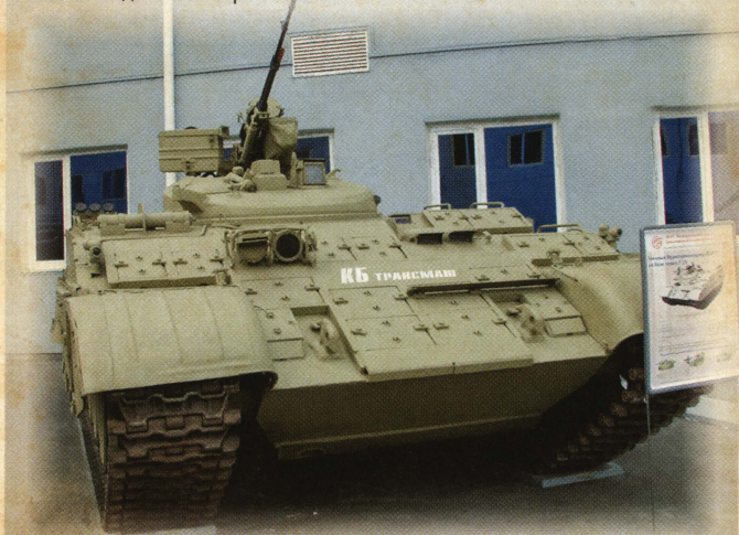
Тяжелый бронетранспортер БТР-Т, вид спереди. Хорошо видны блоки динамической защиты «Контакт-5» на лобовой части корпуса.
